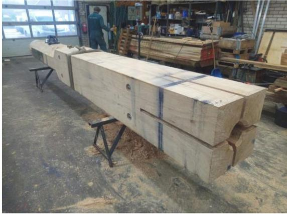
Das Vorderteil der Rutenwelle ist aus Stabilitätsgründen bis zum Sitz des Kammrades viereckig ausgeführt. Vorn ist die (durchgängige) Bohrung zu erkennen, durch die später die Zugstange geführt wird. Mit der Zugstange wird die Stellvorrichtung für die Jalousie-Flügel betätigt. Je nach Windstärke kann damit die erzeugte Antriebskraft per Hand reguliert werden. Die Schlitzte in der Rutenwelle dienen zur Befestigung des Wellkopfes.
